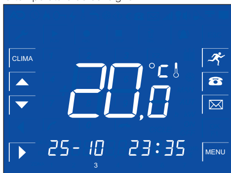
Au bout de 5 secondes sans modification de la température de consigne, la température ambiante est de nouveau affichée.
