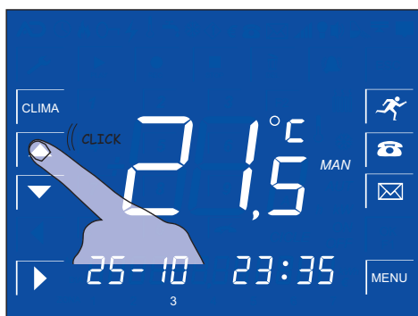
Appuyez sur la touche pour faire monter la température de consigne
